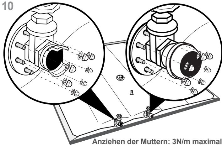
Anziehen der Muttern: 3N/m maximal
